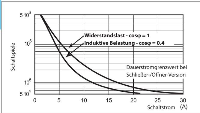
H 65 - Gleichstromschaltvermögen bei DC1 - Belastung
