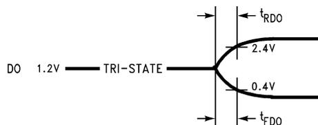
Figure 44. DO “TRI-STATE” Falling and Rising Edge
