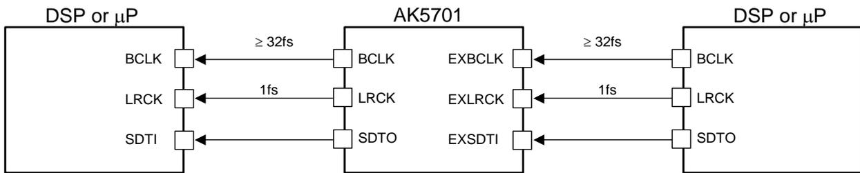
Figure 24. Bypass Mode
