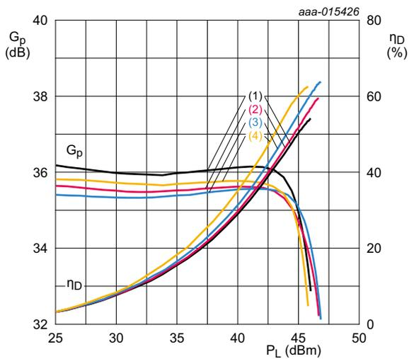
$T_{case} = 25\text{ }^\circ\text{C}$ ;  $V_{DS} = 28\text{ V}$ ;  $I_{Dq1} = 30\text{ mA}$ ;  $I_{Dq2} = 120\text{ mA}$ . Per section.
