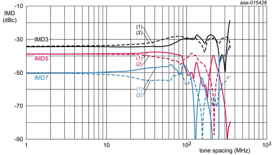
$T_{case} = 25\text{ }^{\circ}\text{C}$ ;  $V_{DS} = 28\text{ V}$ ;  $I_{Dq1} = 30\text{ mA}$ ;  $I_{Dq2} = 120\text{ mA}$ ;  $f = 881\text{ MHz}$ ; 2-tone CW;  $P_L = 8\text{ W}$ . Per section.
