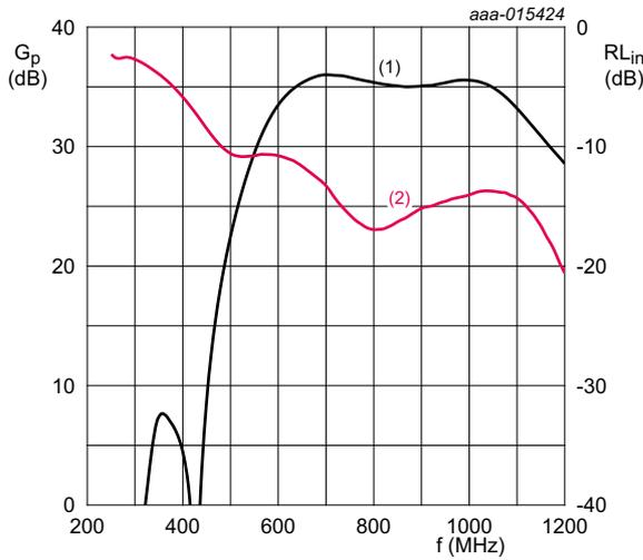
$T_{case} = 25\text{ }^\circ\text{C}$ ;  $V_{DS} = 28\text{ V}$ ;  $I_{Dq1} = 30\text{ mA}$ ;  $I_{Dq2} = 120\text{ mA}$ ;  $P_L = 0.25\text{ W}$ . Per section.
