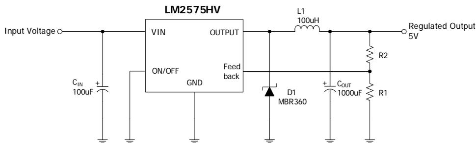
$$* V_{OUT} = V_{REF} \left(1 + \frac{R2}{R1}\right)$$
