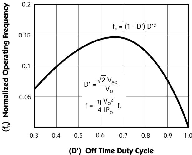
FIGURE 32 — NORMALIZED OPERATING FREQUENCY vs. OFF-TIME DUTY CYCLE
