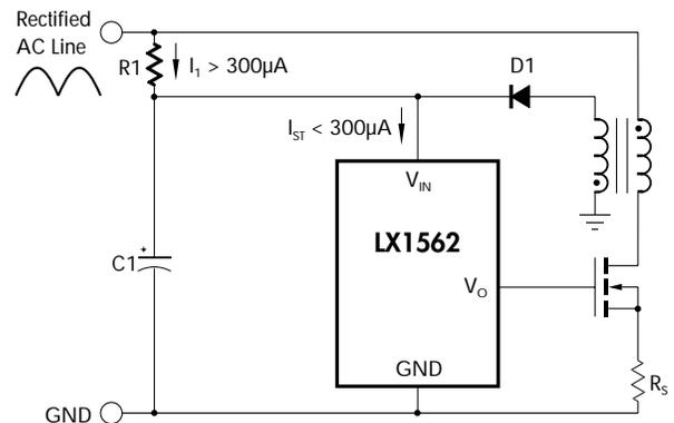
FIGURE 24 — TYPICAL APPLICATION OF START-UP CIRCUITRY
