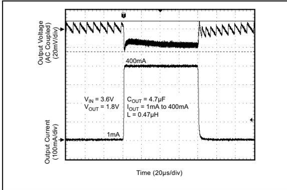
**FIGURE 2-25:** Load Transient.
