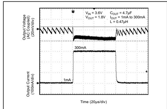
**FIGURE 2-24:** Load Transient.
