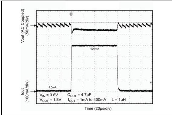
**FIGURE 2-25:** Load Transient.
