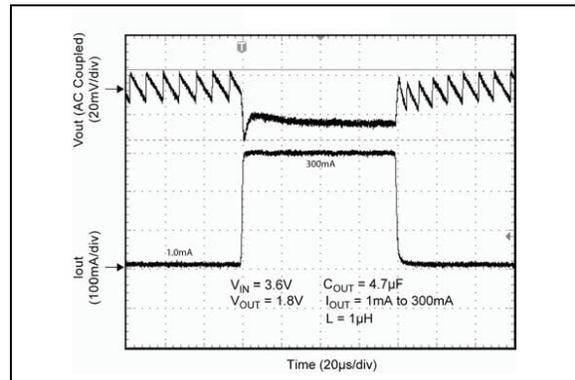
**FIGURE 2-24:** Load Transient.
