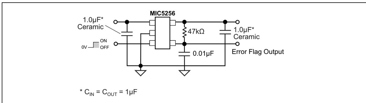
**FIGURE 1-1:** Test Circuit.
