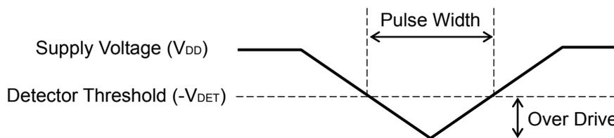
**V<sub>DD</sub> Input Waveform**
