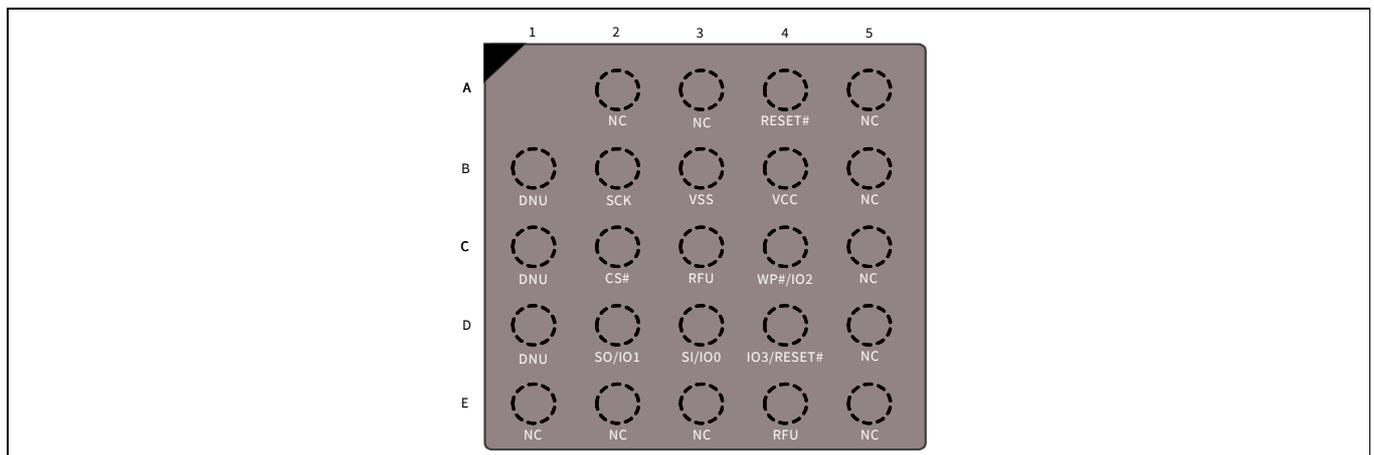
**Figure 3** 24-ball BGA, 5 × 5 ball footprint (FAB024), top view<sup>[4]</sup>
