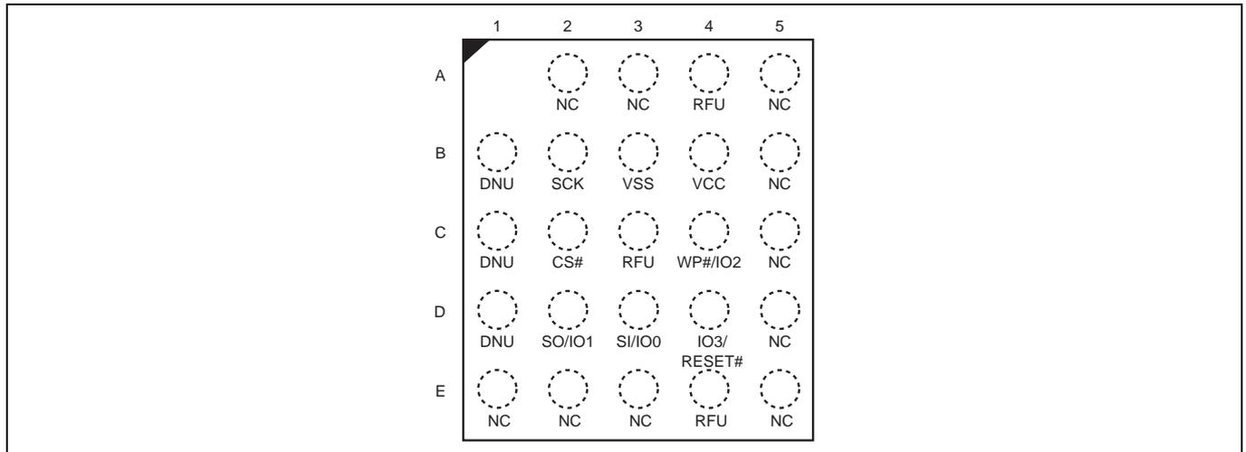
**Figure 3** 24-ball BGA, 5 x 5 ball footprint (FAB024), top view<sup>[9, 11]</sup>
