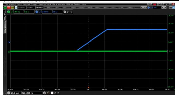
Blue>>AVCC, Green>>DAC OUTPUT AVSS = AV EE = AGND, AV CC = 0 to 12 V
