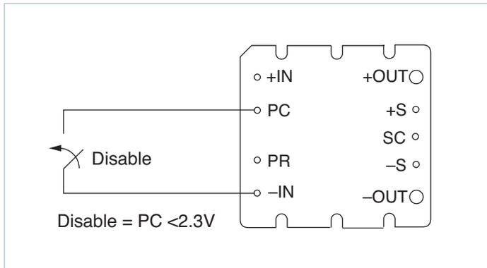
Figure 2 — Module enable/disable
